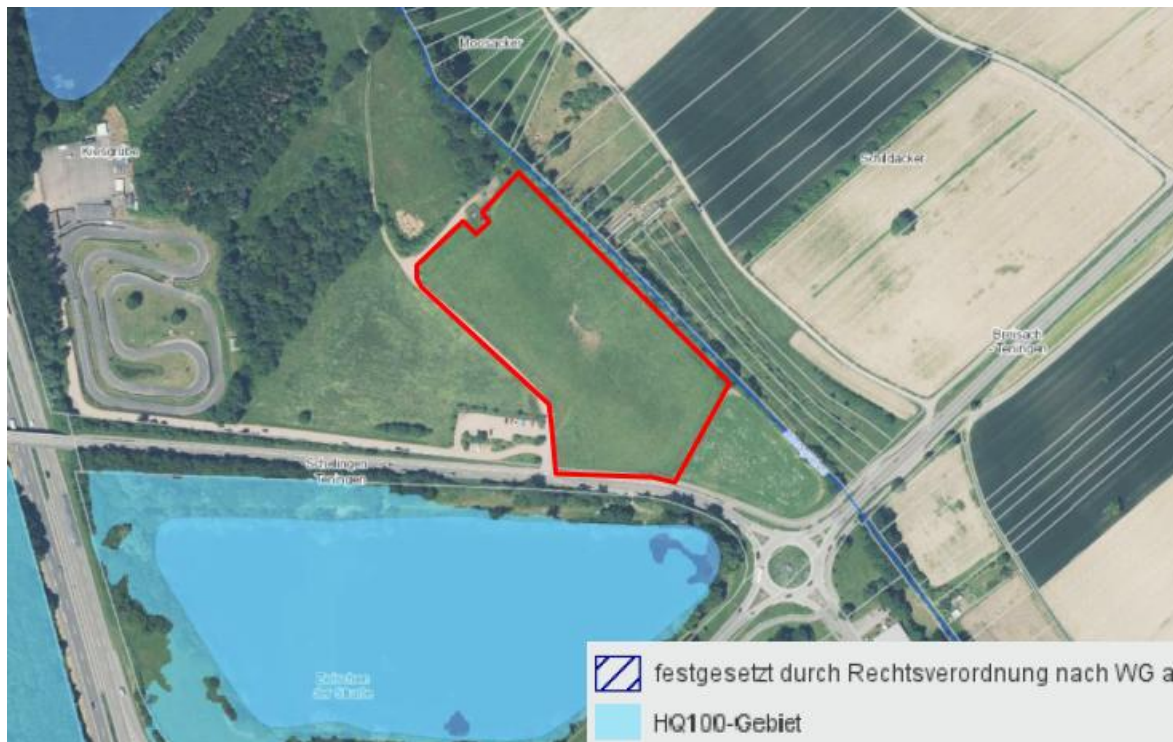
Abbildung 2: Ausdehnung der Überflutung bei HQ100; Quelle: LUBW 31.05.2021, eigene Darstellung
